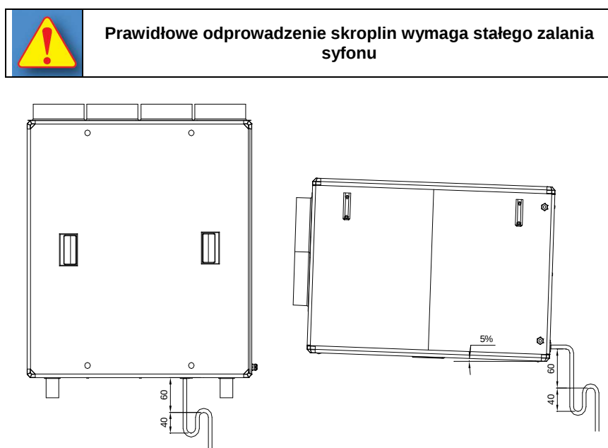
Rys. Nr 5 Syfon na skropliny w KCO i pochylenie wersji podwieszanej.
