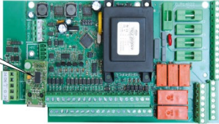
Rys. Nr 25 Karta Ethernet i sposób jej montażu.
